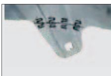
Волнистые скобы с крупной и мелкой змейкой 0.6 мм для ровных поверхностей на тонком пластике.
