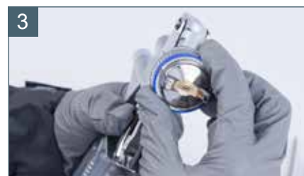
Установите воздушную головку
