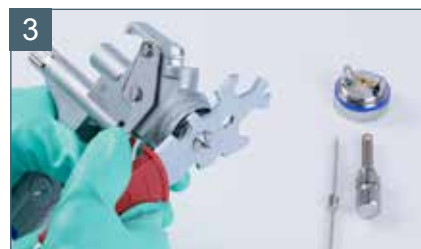
В завершение с помощью накидного гаечного ключа, встроенного в универсальный инструмент, вывинчивается красящая форсунка.
