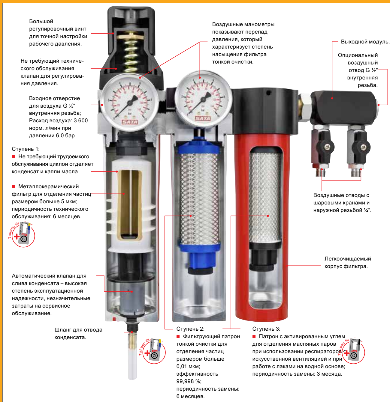
Модель SATA filter 484 в разрезе
