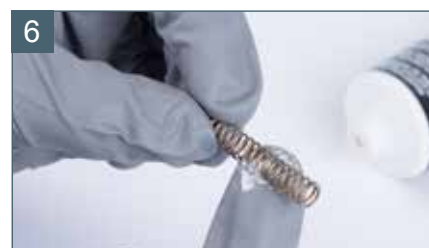
Смажьте и вставьте пружину окрасочной иглы
