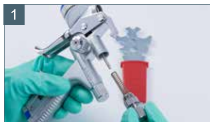
Сначала отсоедините покрасочную иглу.
