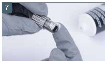
Смажьте резьбу винта-регулятора подачи материала
