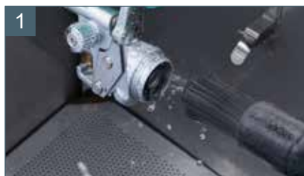
Очистите канал для подачи материала
