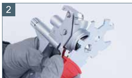
Затяните дюзу при помощи универсального ключа
