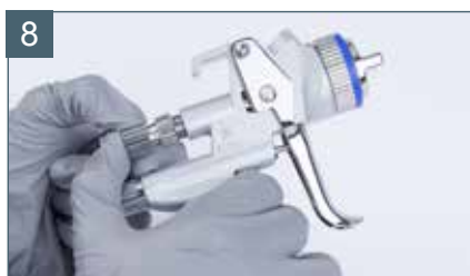
Установите винт-регулятор подачи материала
