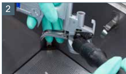
Очистите корпус окрасочного пистолета
